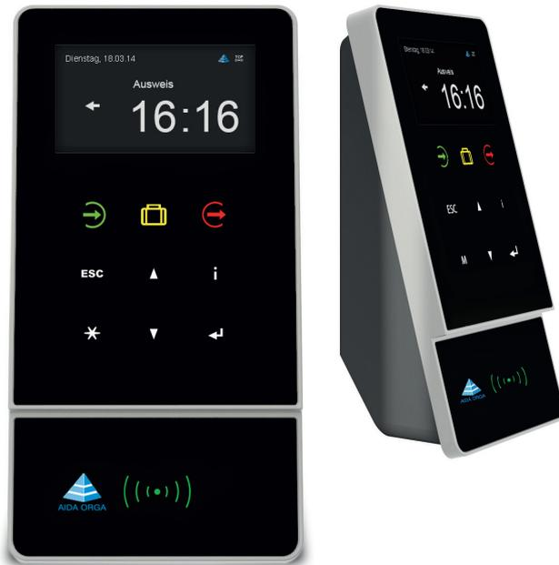
High-End Multifunktionsterminal zum Betrieb an einen Server/PC mit Betriebssystem Windows Server 2008 / 2012, Windows 7 / 8 / 10 für Zeiterfassung, Betriebsdatenerfassung und Zutrittskontrolle.
